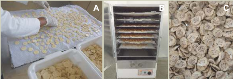
Figura 3. Distribuição das fatias nas bandejas (3A); fatias de banana verde no desidratador (3B); e fatias de banana desidratadas (3C).
